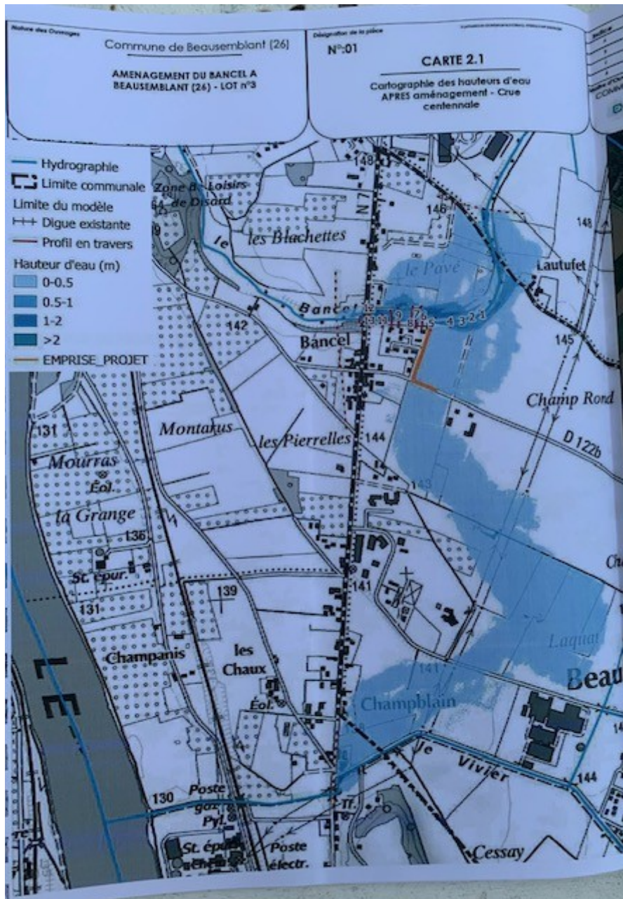
Figure 4- Situation du lotissement « Les Mirabelles » et du hameau de BANCEL au cours d'une Inondation Q100 APRES REALISATION DU PROJET.
